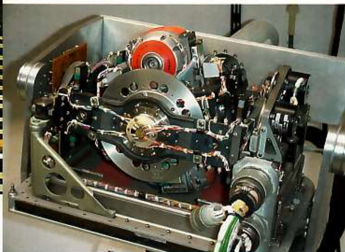
De gyrotolunit, het hart van het traagheidsnavigatiesysteem van de F-104.
